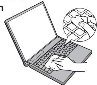
**3 Heben Sie den Computer langsam hoch und halten Sie ihn dabei gerade. Wischen Sie das aus den Löchern auf der Unterseite kommende Wasser mit einem weichen, trockenen Tuch ab.**
