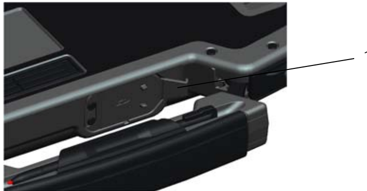
1 Griff der Secure Digital-Klappe in herausgezogener Position
